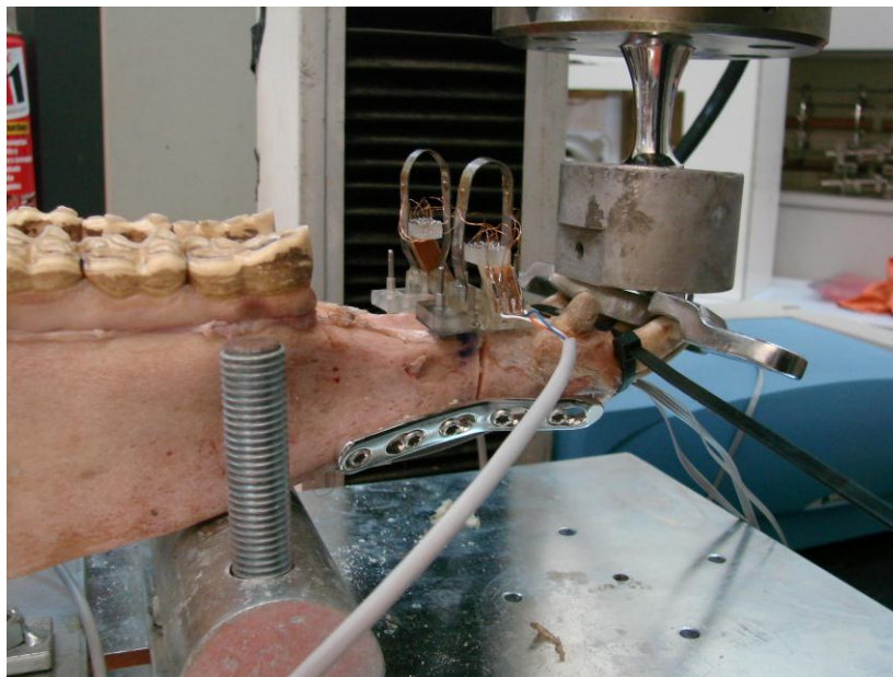
Figura 21: - Peça anatômica de equino. Mandíbula posicionada no dispositivo mecânico para ensaio de flexão com os transdutores inseridos ao redor da osteotomia no diastema mandibular
