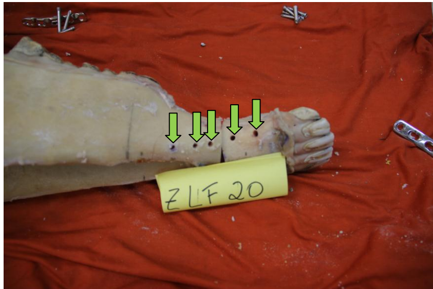
Figura 24: - Mandíbula 20 do grupo 2 (osteossíntese com placas LCP) após os ensaios biomecânicos e retirada dos parafusos. Todos os locais de perfuração óssea para instalação de implante estavam íntegros e sem sinais de estresse resultante da carga aplicada (setas verdes)
