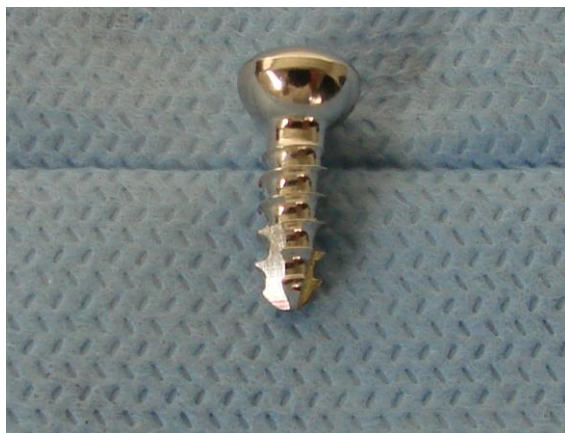
Figura 4: - Parafuso autorosqueante/trefinante. Configuração da ponta com um corte em linha
