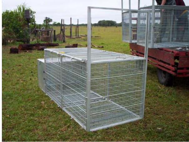
Figura 31- Aspecto de uma das armadilhas construídas pela Fermarame - SP. O dimensionamento foi feito de acordo com dados biométricos das espécies-alvo da pesquisa
