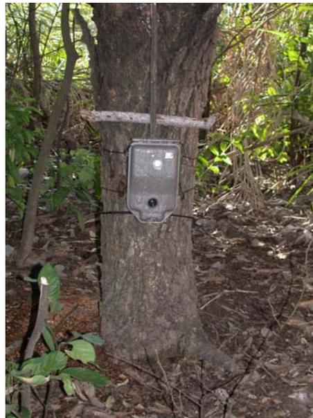
Figura 26- “Armadilha fotográfica” utilizada na área de várzea da propriedade rural. Tal dispositivo captura imagens em fotografia através de sistema automático por infravermelho que é acionado quando o animal passa na frente do equipamento
