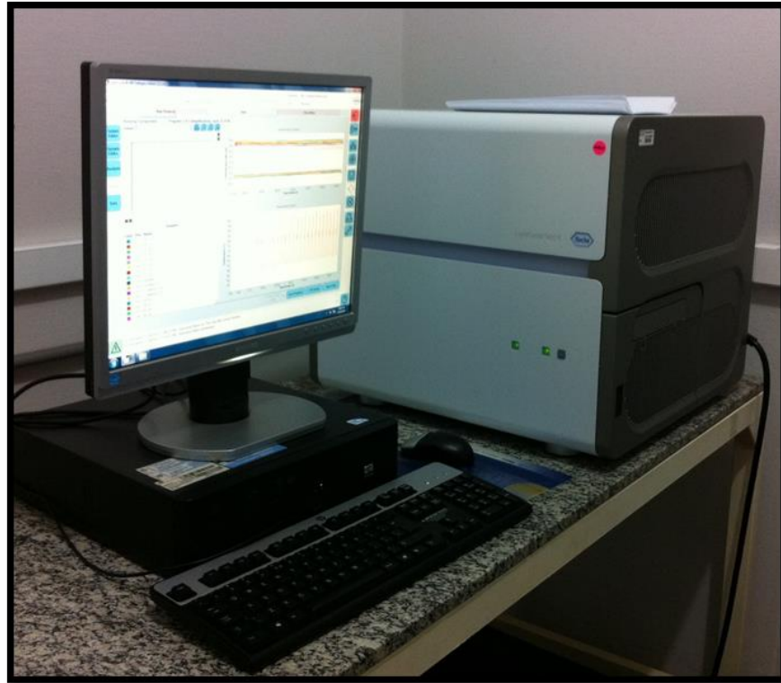
Figura 2 - Termociclador de qPCR- LightCycler 480 II (Roche Diagnostics, Manheim, Alemanha) conectada ao computador -LMSA&SA, FZEA/USP
