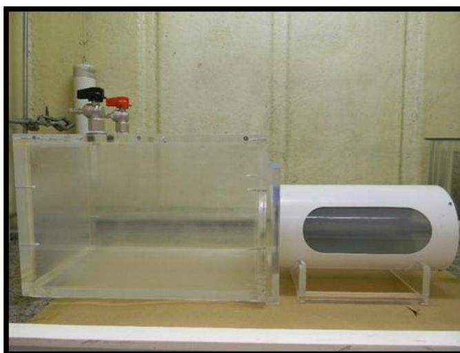
Figura 16 - Equipamento de exposição montado com suas câmaras, a de exposição e a antecâmara de espera.
