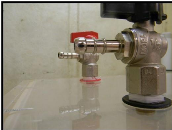
Figura 12 - Detalhe das válvulas de ½ polegada do tipo esfera inseridas por meios de rosqueamento no topo da câmara de exposição.
